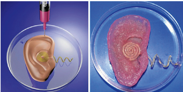
FIGUUR 4 Het printen van een hydrogel met cellen kan worden gecombineerd met het printen van direct functionele onderdelen zoals een metalen ontvanger en geleider voor geluid (elders gepubliceerde figuur). 5
