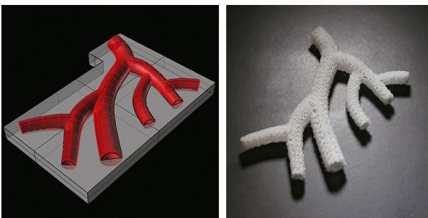
FIGUUR 2 Complexe vormen zoals deze vaatstructuur kunnen worden geprint van bioafbreekbaar plastic. Op deze structuren kunnen cellen en groeifactoren worden gezaaid om weefselherstel te bevorderen (elders gepubliceerde figuur). 3
